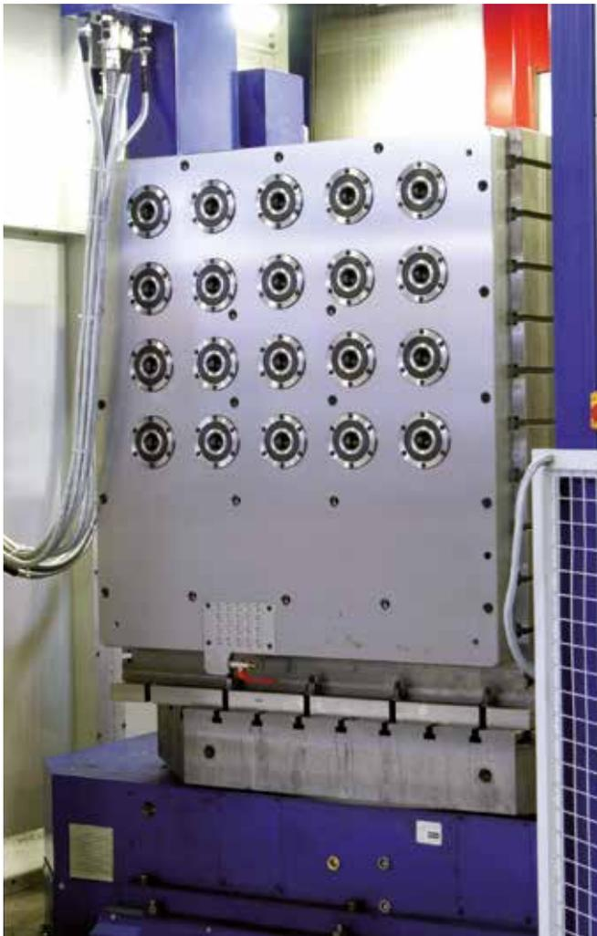
**Das Nullpunktspannmodul UNILOCK ESM 138 wurde direkt in den Maschinentisch einer MATEC HV eingebaut.** Der Rundtisch sowie die Seitentische verfügen über denselben Raster für den Aufbau von Schraubstöcken, Vorrichtungen und Rasterplatten.
