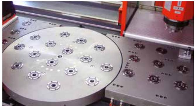
**Unilock Nullpunktspannplatte mit teileingebauten ESM 138, die auf einer 5-Axis Maschine aufgebaut wurde.** Das Formenbauunternehmen verwendet diese UNILOCK Spannplatte zur Aufnahme von Paletten, Magnetplatten (siehe Bild) oder Werkstücken.
