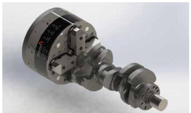
Typ 4OVEKA 206. Spannen von Kurbelwellen zwischen Spitzen zum Schleifen der Hub- und Hauptlager
