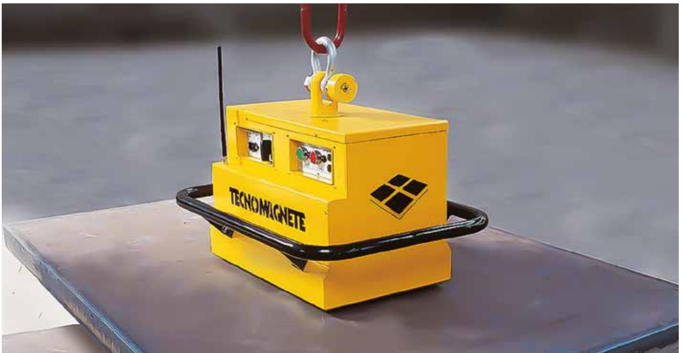
TECNOMAGNETE hat diese höchst innovative Technologie als QUADRATPOLSYSTEM entwickelt und patentiert. Die Magnetpole an der Lastaufnahme­fläche sind schachbrettartig angeordnet, um dort eine große Kraftkonzentration zu erzeugen wo sie benötigt wird. Die „neutrale Krone“ der Module vermeidet eine Streuung des Magnetfeldes und stellt die komplette Isolierung der stark konzentrierten Kraft der Permanentmagnete sicher.
