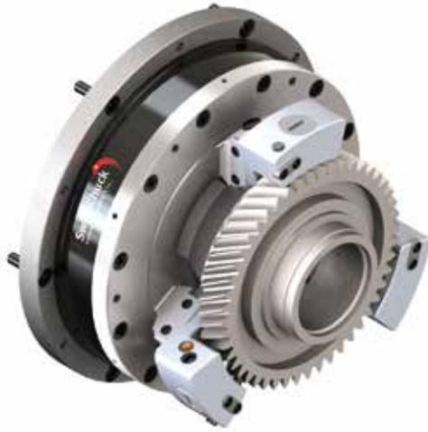
*Schrägverzahntes Getrieberad: Spannung im Teilkreis mit Rückzug auf Axialanschlag, Schleifen der Bohrung und Aussen-durchmesser*
