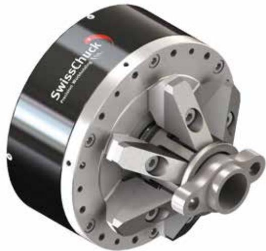
Membranspannfutter 6MCHP 160 So. Aussenspannung mit Rückzug auf Axialanschlag, Schleifen der Bohrung und Stirnseiten
